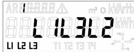
Figur 25: Feil rekkefølge på faser.
