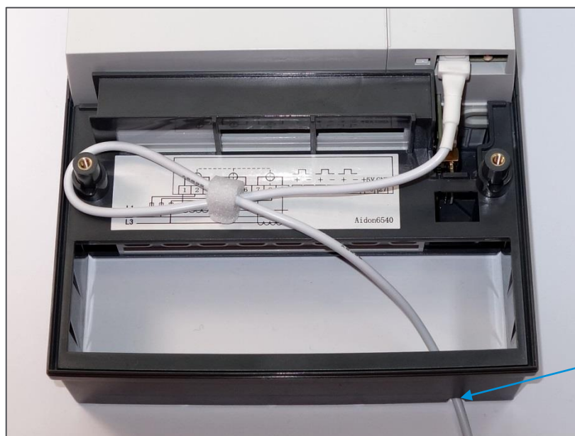
Figur 15: Kabel installasjon for 3-fase med langt deksel.
